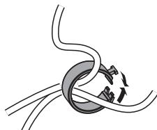
**3.** 握住閉合部份的同時將線材固定槽插入支架底座。
