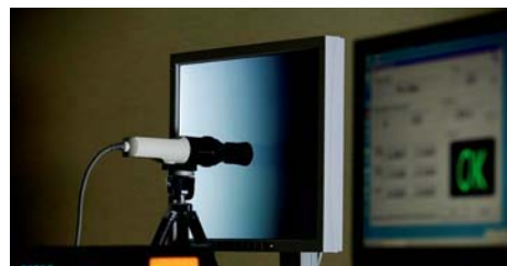
圖10. 每台顯示器會在工廠作調整(為了說明性的目的。真實調整會在暗室裡進行)
